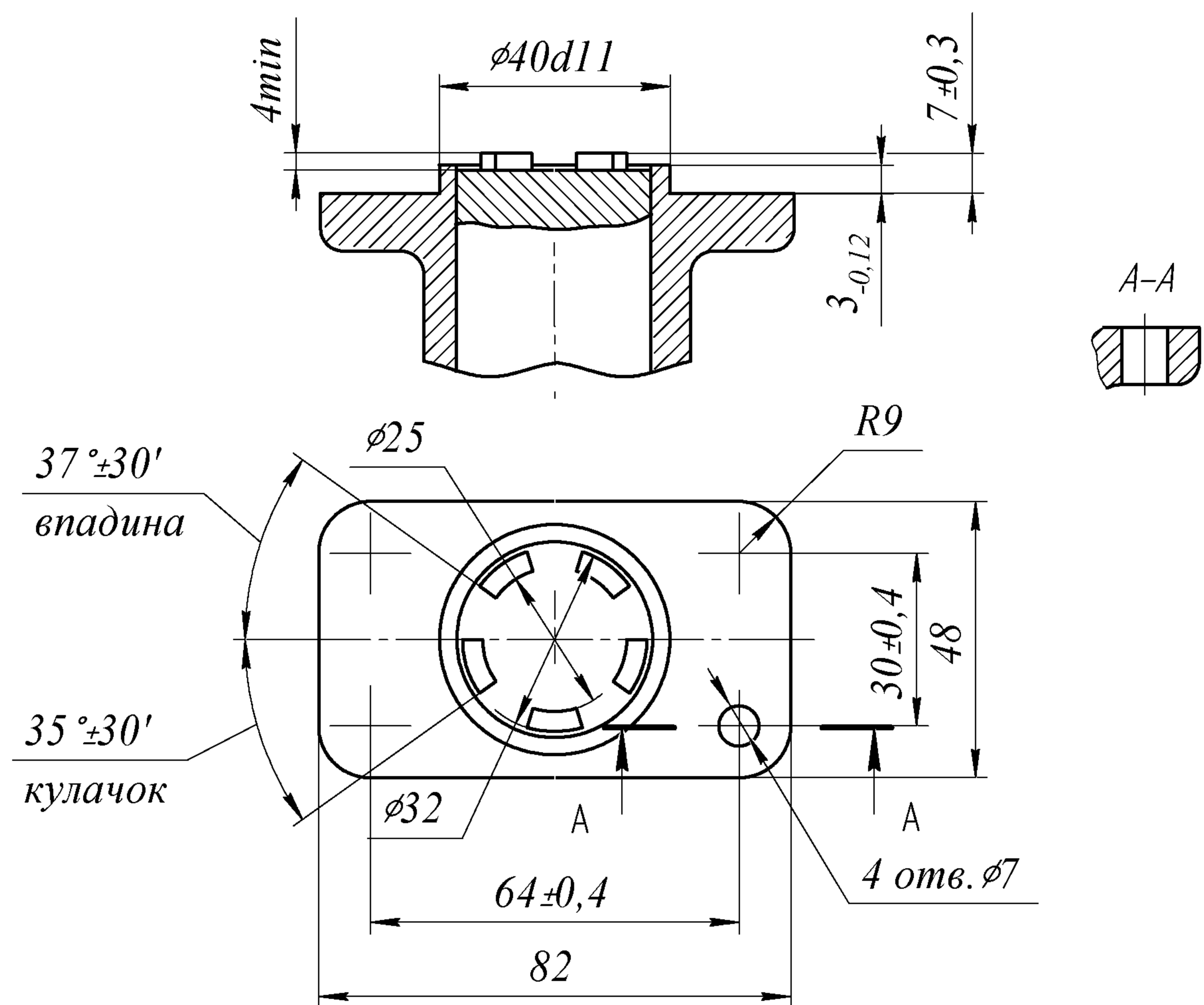
Рисунок А.4 – Ответное присоединение трубопроводной арматуры типа МК
