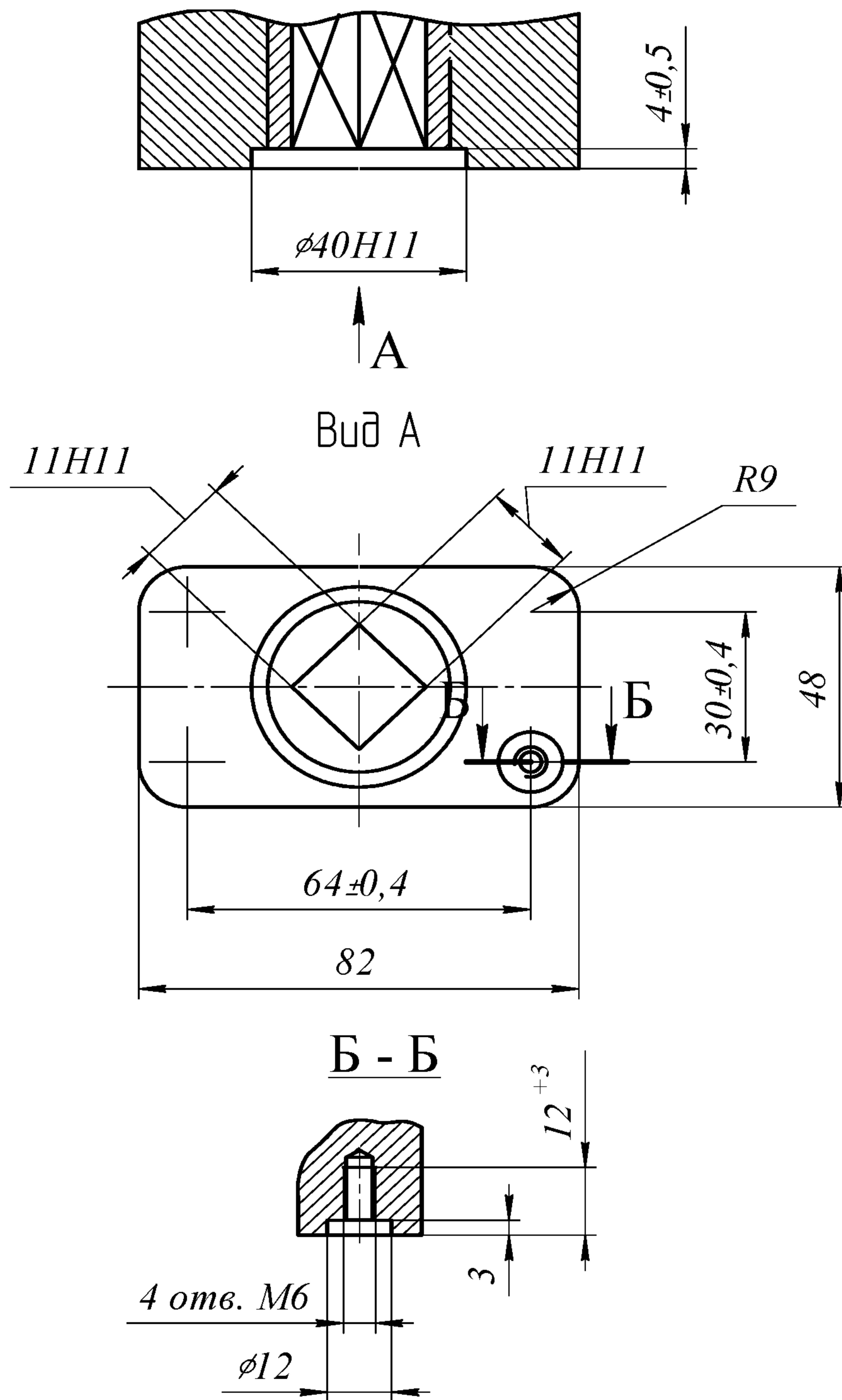
Рисунок А.1 – Присоединение привода типа МЧ
