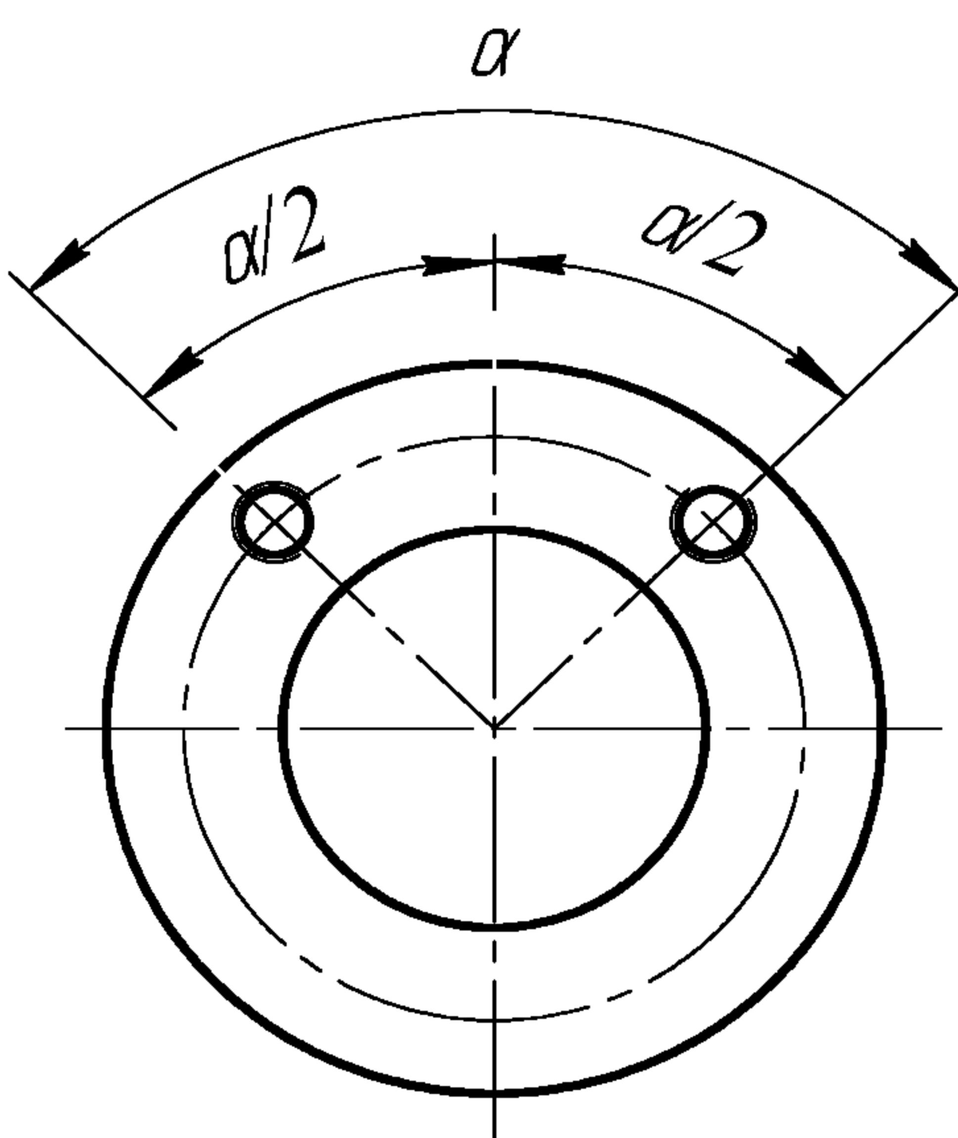
Рисунок 3 – Расположение отверстий для типов присоединений F03–F60
