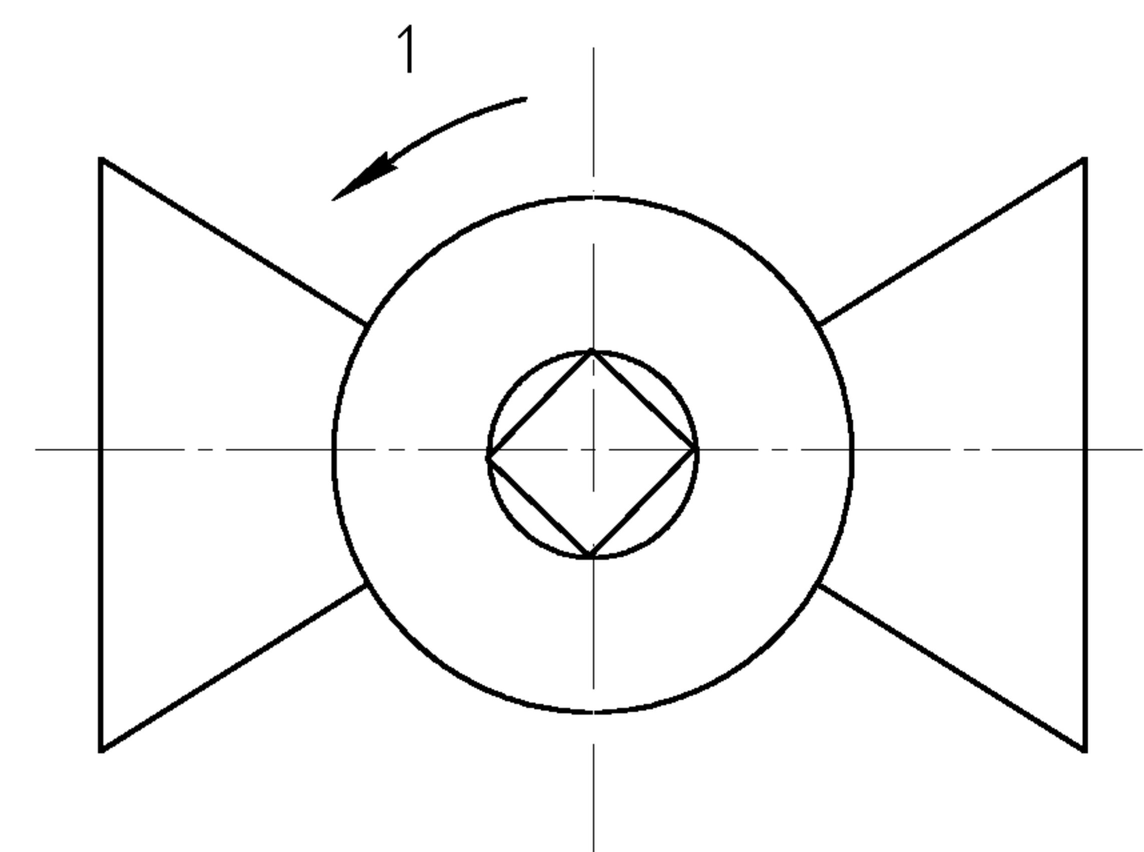
Рисунок 14 – Положение диагональной квадратной головки на закрытой арматуре
