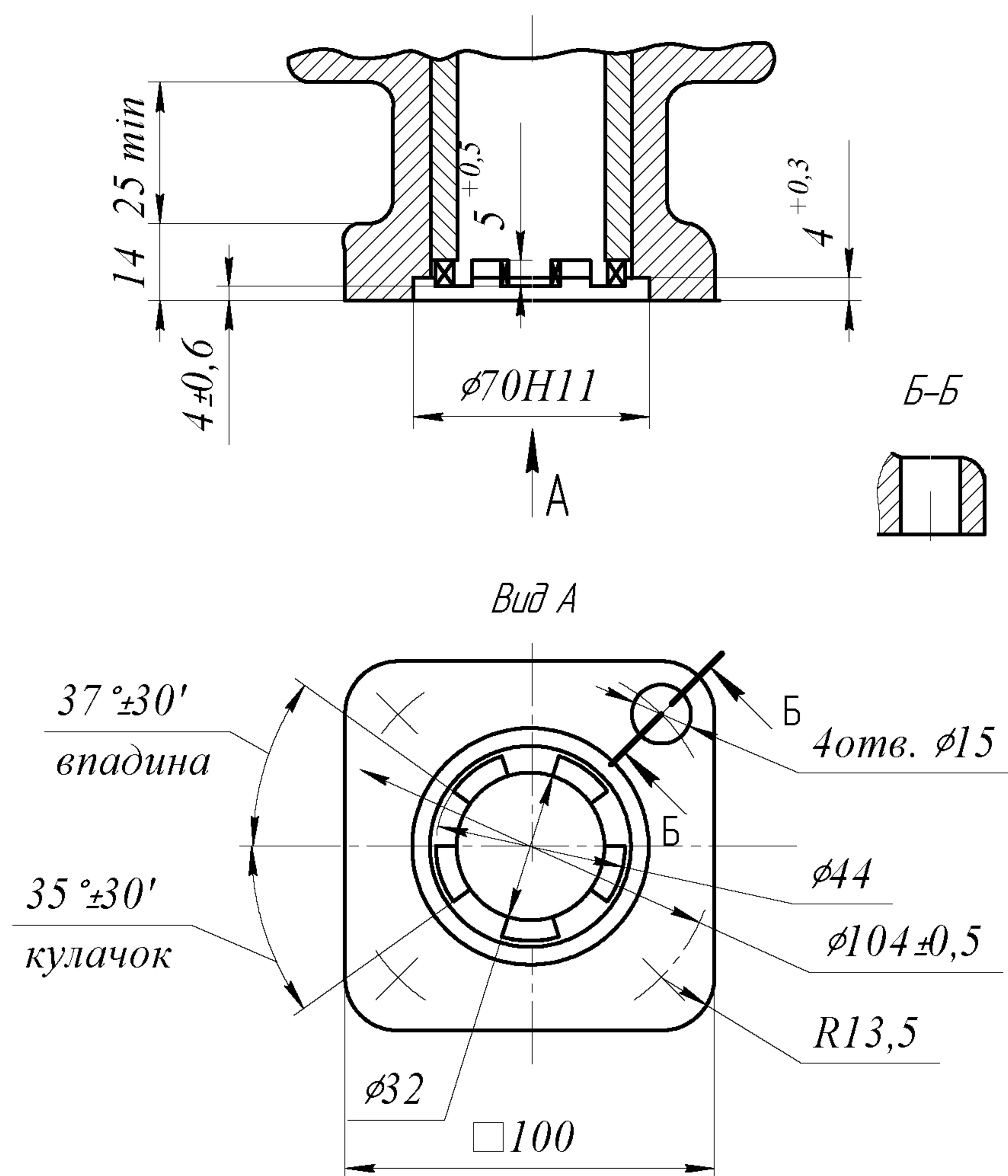
Рисунок А.7 – Присоединение привода типа АК
