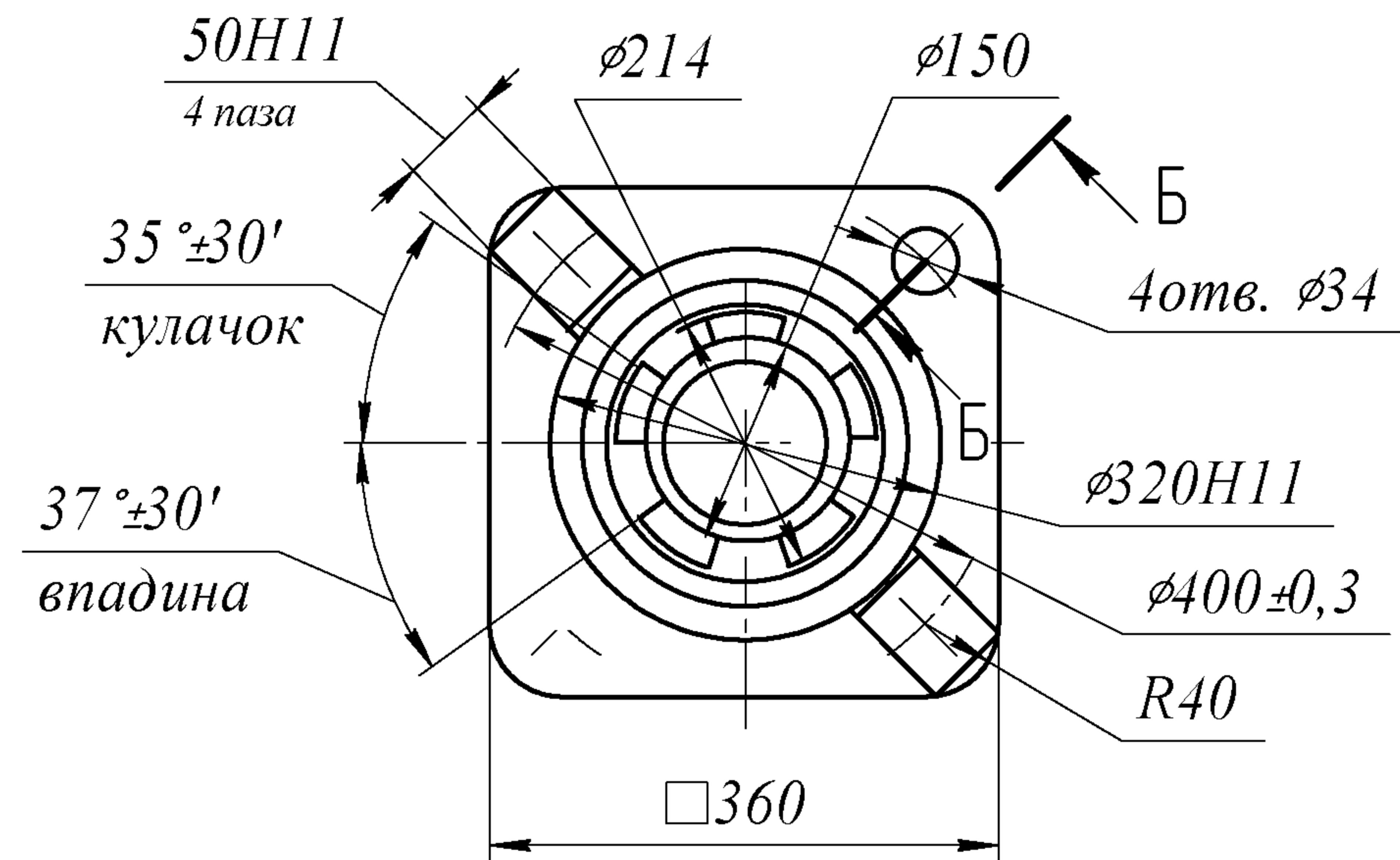
Рисунок А.13 – Присоединение привода типа Д
