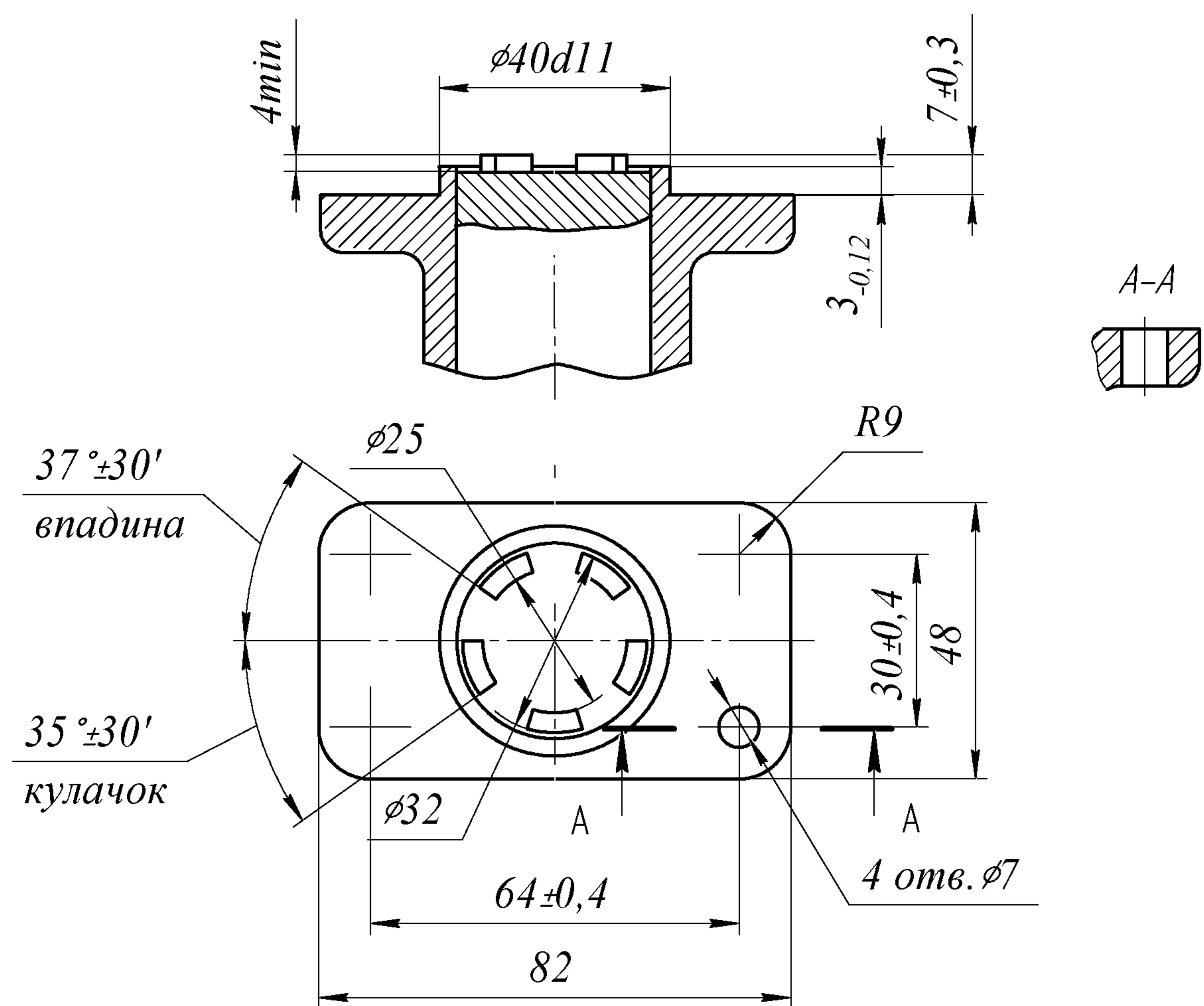
Рисунок А.8 – Ответное присоединение трубопроводной арматуры типа АК
