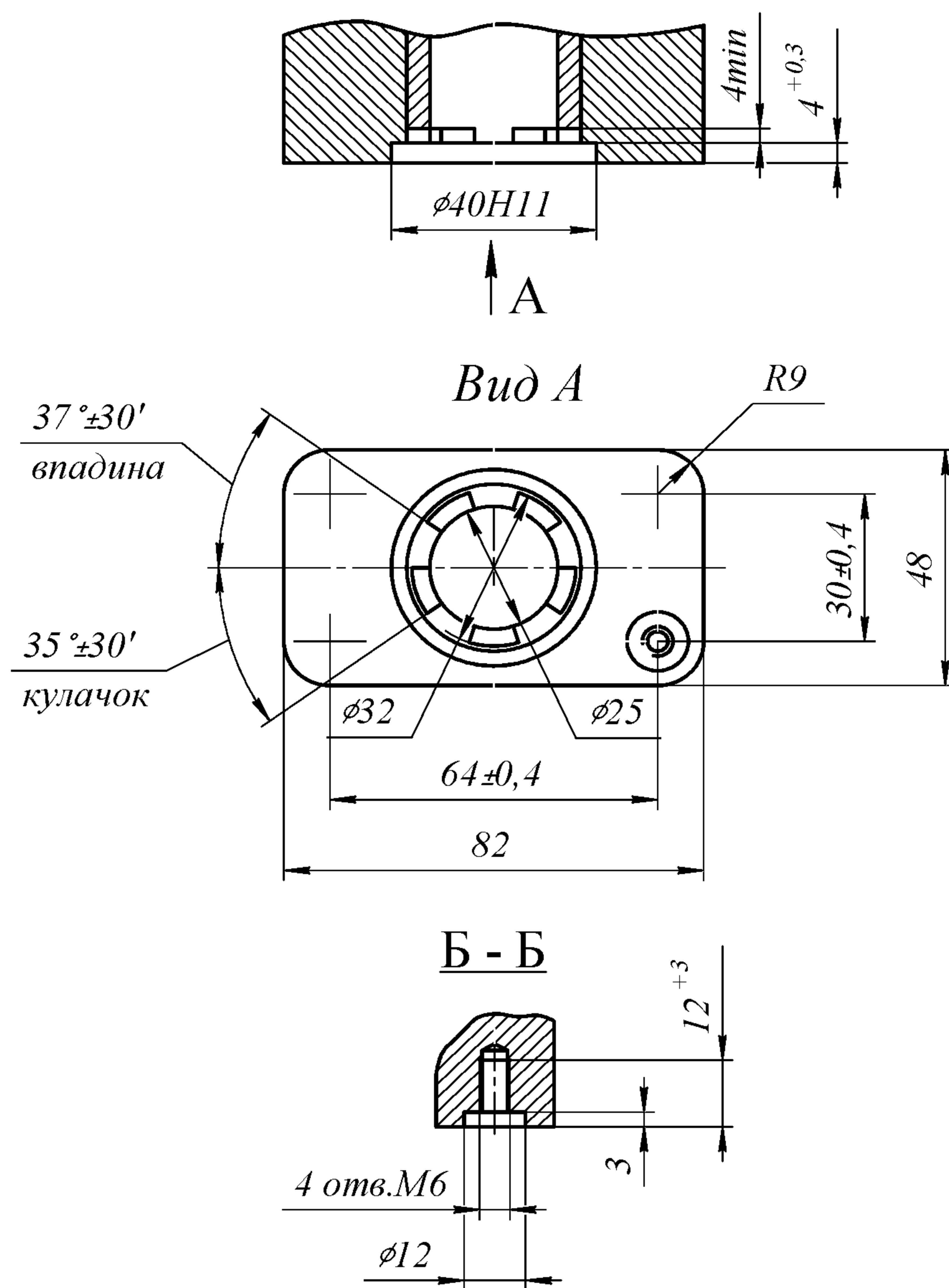
Рисунок А.3 – Присоединение привода типа МК
