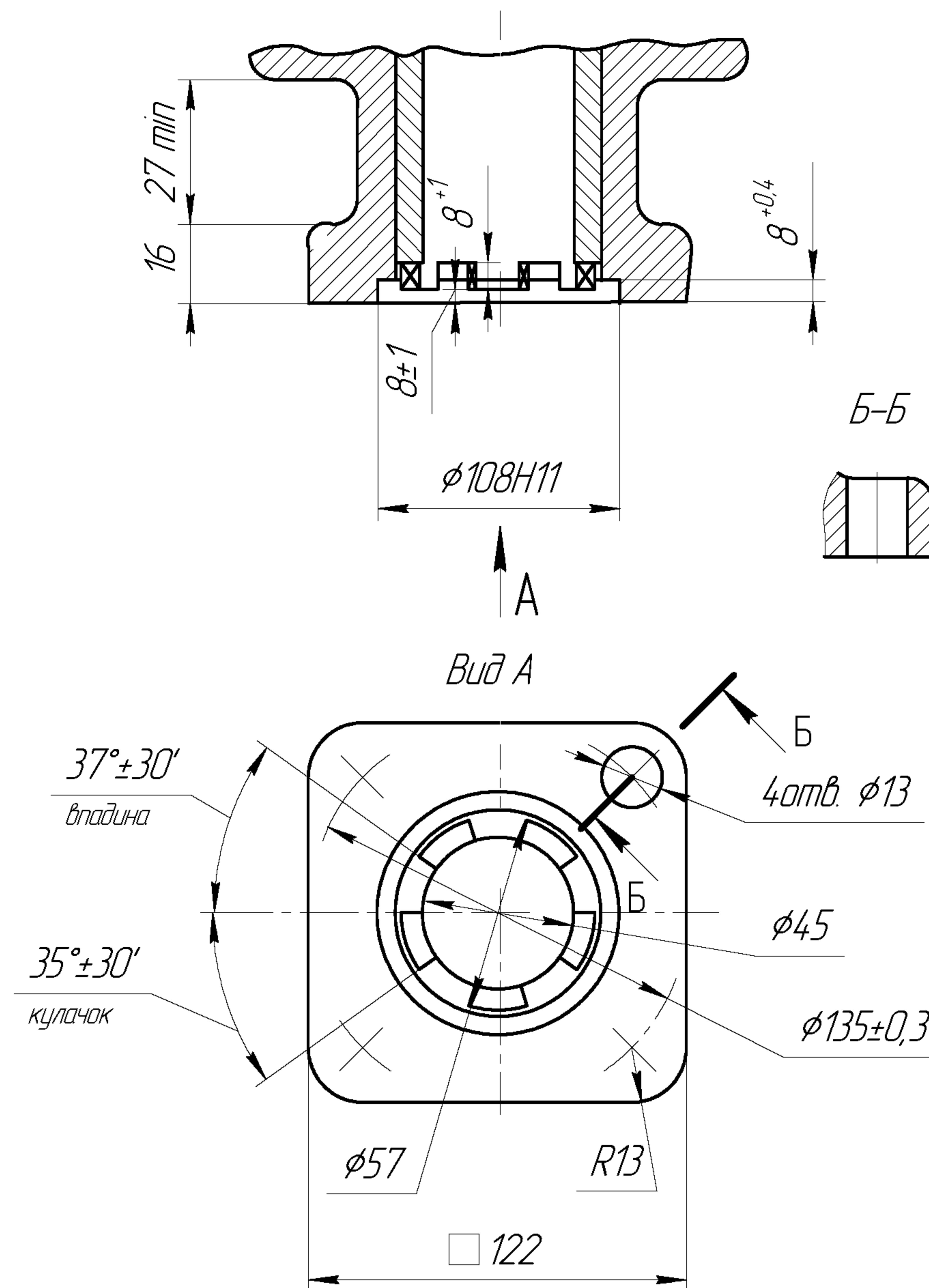
Рисунок А.9 – Присоединение привода типа Б
