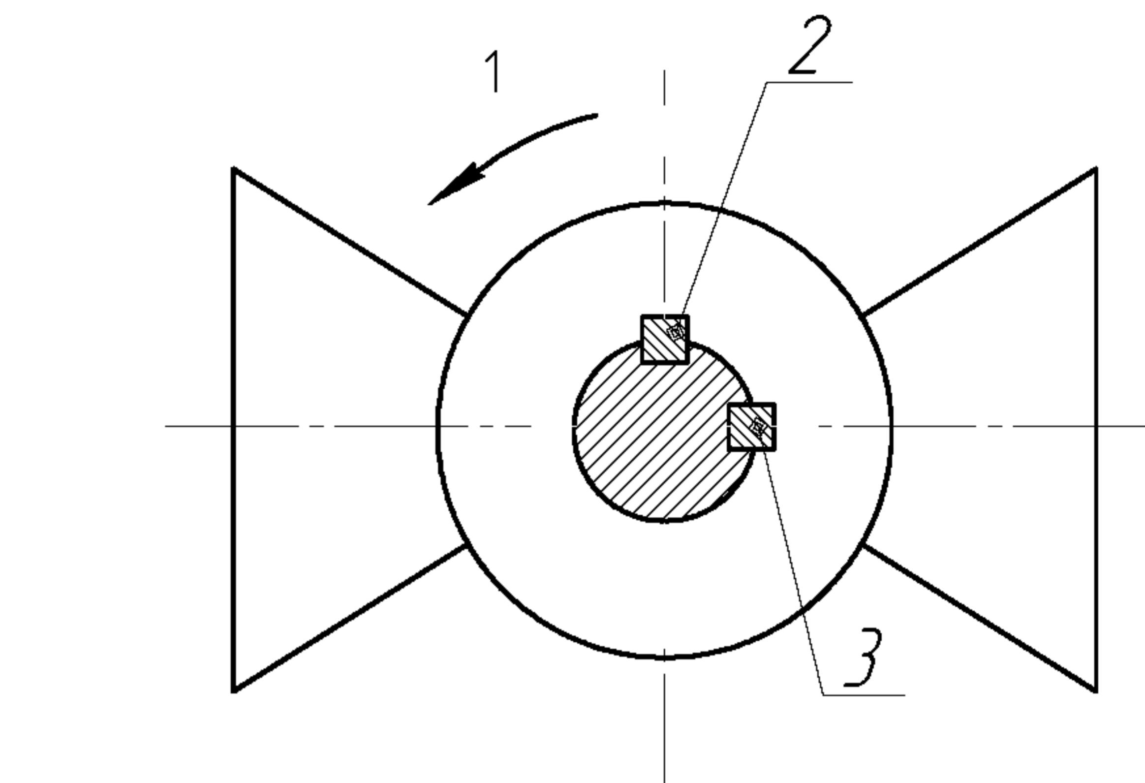
Рисунок 10 – Положение двух шпонок
