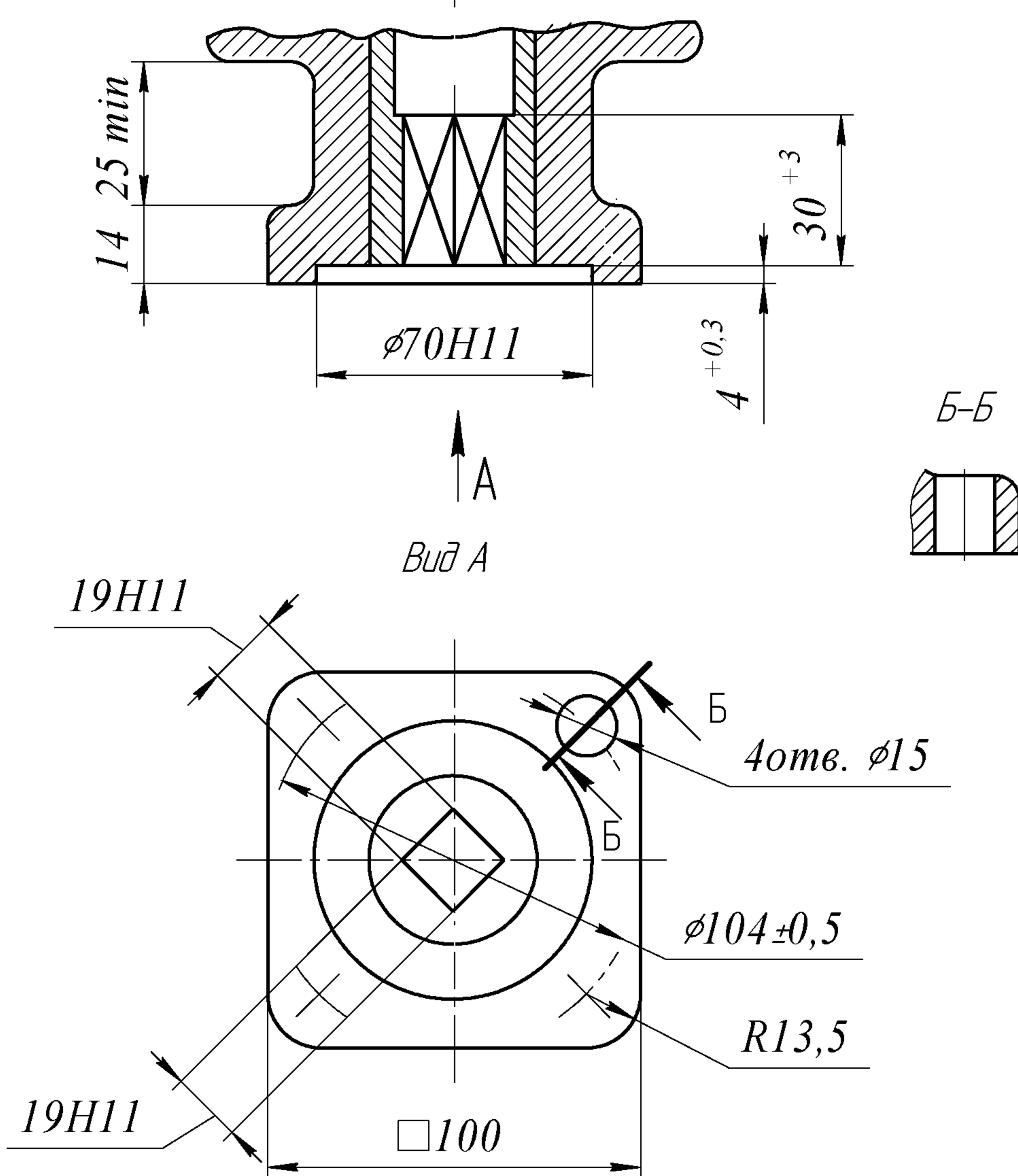
Рисунок А.5 – Присоединение привода типа АЧ
